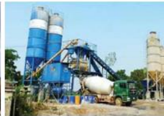
Trạm trộn bê tông Concrete Batching
